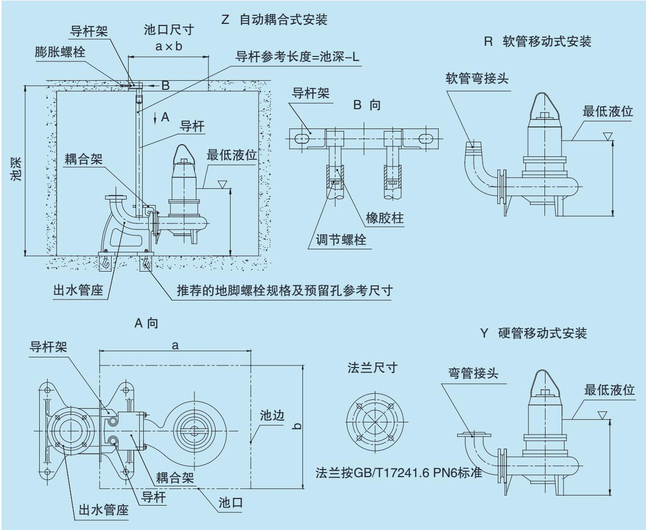
自动耦合式安装无须用常规的紧固件来连接泵和管道。耦合装置只有出水管座、导杆、导杆架、耦合架这四样东西。导杆只起导向作用，不受力，用普通自来水管或钢管按池深切割成需要的长度就可以了，所以用户可以自备。安装时，把出水管座、导杆、导杆架装好，把耦合架装到泵体上，吊起泵，将耦合架上的半圆孔口穿入导杆，把泵沿导杆向下滑到底，耦合架就会与出水管座对齐扣紧。需要维修泵时，只需把泵向上提，
